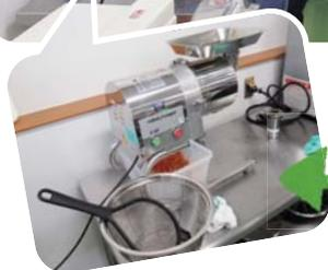
裏ごし処理機(写真奥)。機械上部のバットに入れると、果汁とそれ以外に分けてくれる。量が少なければ手作業でも。ストレーナー(写真手前)を使えば目詰まりしにくい。
