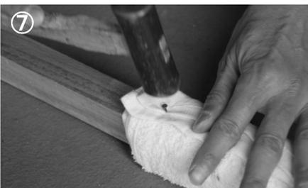
⑦ 巻いたタオルの**上端**に釘を打ち込む。（釘は全部打ち込まない。）
