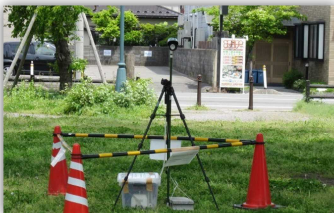
一般環境騒音調査の様子
