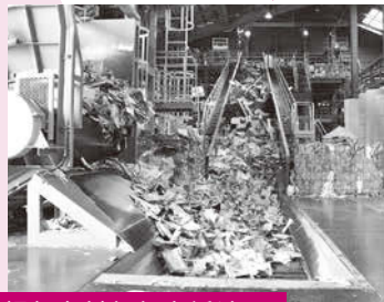
梱包を外した古紙はコンベヤで運ばれます
