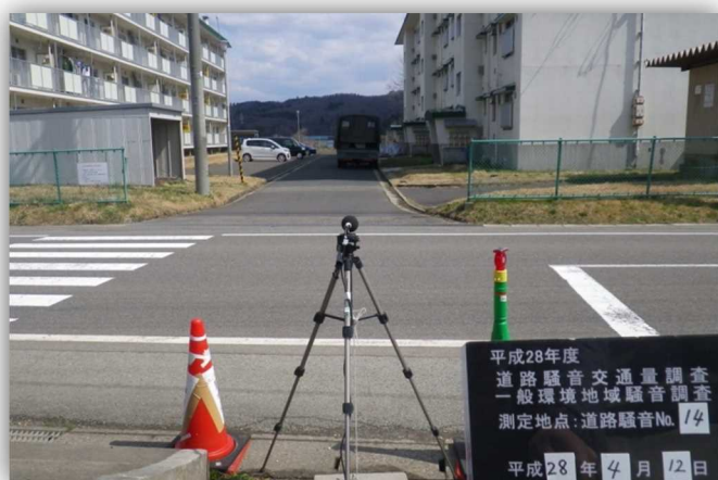
道路騒音調査の様子
