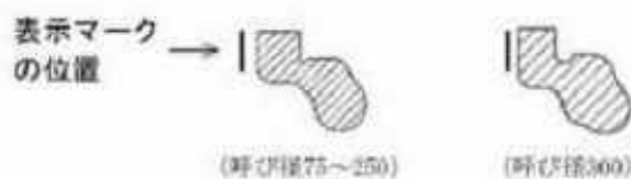
図-3.16 ゴム輪(直管用)の表示マーク位置
