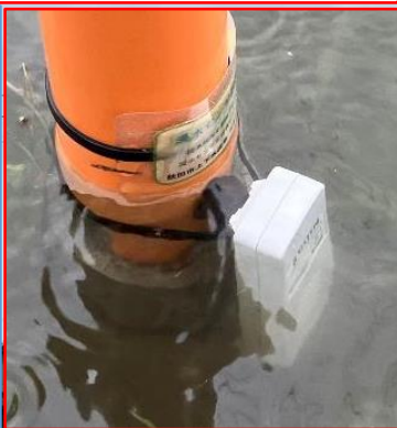
浸水センサ検知状況 飯島新町三丁目 R7/9/2
