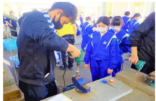
● ドリルの先にテープで3cmの所に印を付け、万力で固定し穴あけする。
