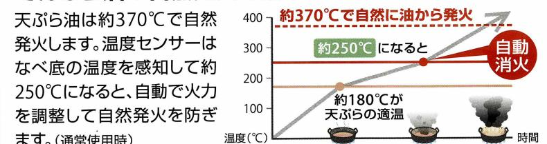
コンロ火災は、その多くが調理中にうっかりその場を離れたり、過熱しすぎて火災に至っています。Siセンサー搭載コンロは、うっかり過熱した際にセンサーが温度を感知、ガスの火を安全に止め事故リスクを下げます。
