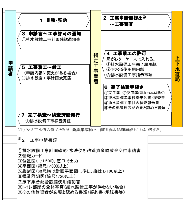
図3-3 排水設備工事申請の流れ
