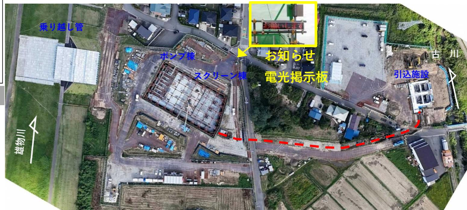
ポンプ場は、仮設山止め支保工解体と、底版上からの柱・壁躯体コンクリート工事を進めて行きます。今月はポンプ場で資機材の搬入搬出車両が多くなります。引き続きポンプ場入り口前の電光掲示板でのご案内をいたします。
