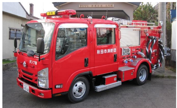
消防団に配置されている車両 （救助資機材搭載型消防ポンプ自動車）
