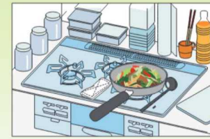
周辺に可燃物が置かれた危険な例
