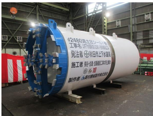
雨水幹線工事に使用するシールドマシン
