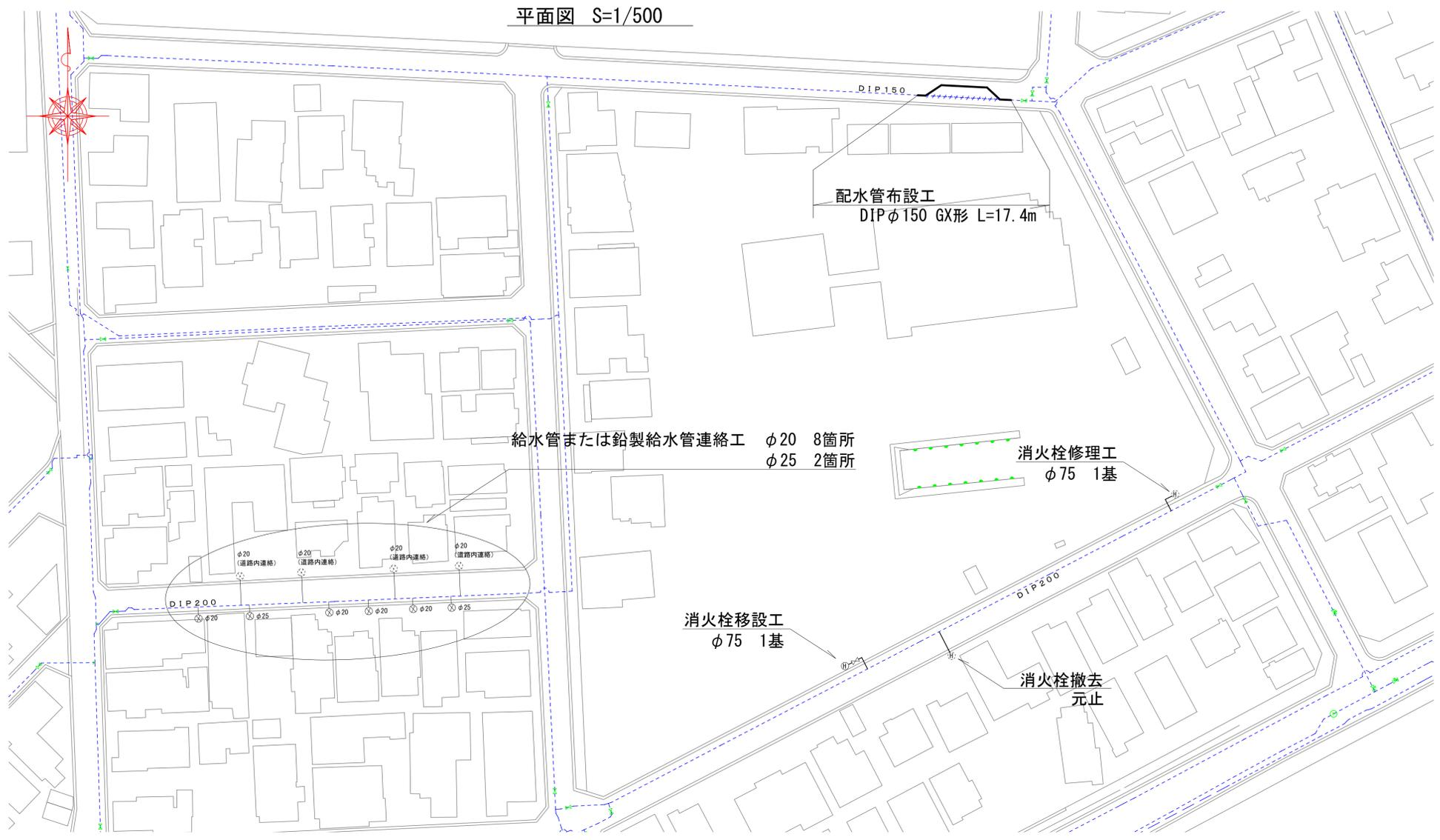
配水管布設工詳細図
