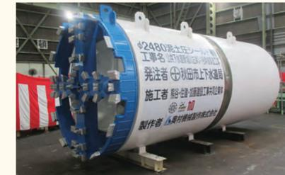
雨水幹線工事に使用するシールドマシン
